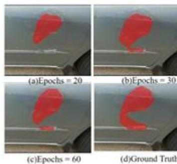
**Fig. 11.** (a) Car Damage Detection Epoch=20 (b) Car Damage Detection Epoch=30 (c) Car Damage Detection Epoch=60 (d) Car Damage Ground Truth label.
